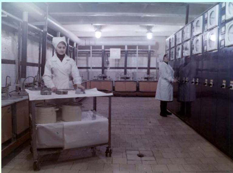
**Рафинирование индия тонкослойным электролизом на ЧЭЦЗ (г. Челябинск).** Используют на Новосибирском олово комбинате, УКСЦК (г. Усть-Каменогорск). При токовой нагрузке 50 А производительность 1 электролизера составляет 5 кг In/сут ( в 3 раза больше, чем при водном электролизе за счет использования соединений индия низших степеней окисления). Обеспечивает получение металла ИН-00. Метод применим для рафинирования Zn, Sn, Cd, Al)
